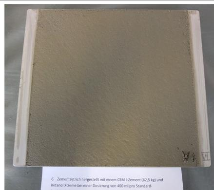
6. Zementestrich hergestellt mit einem CEM I Zement (62,5 kg) und Retanol Xtreme bei einer Dosierung von 400 ml pro Standard-Estrichmischung
