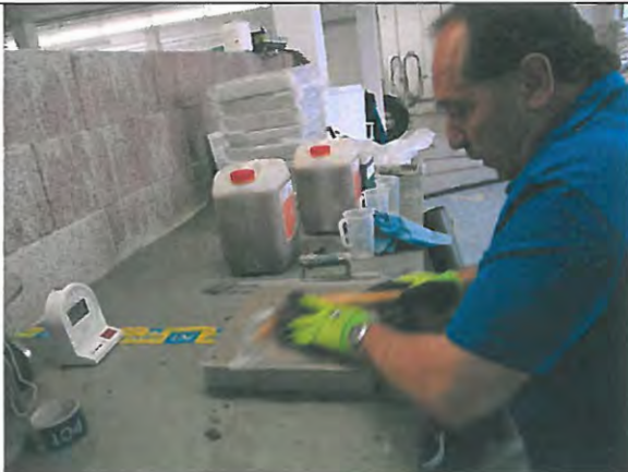
Bild 5: Glätten des Prüfkörpers
