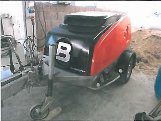
Bild 3: Estrichherstellung mit dem Estrich Boy
